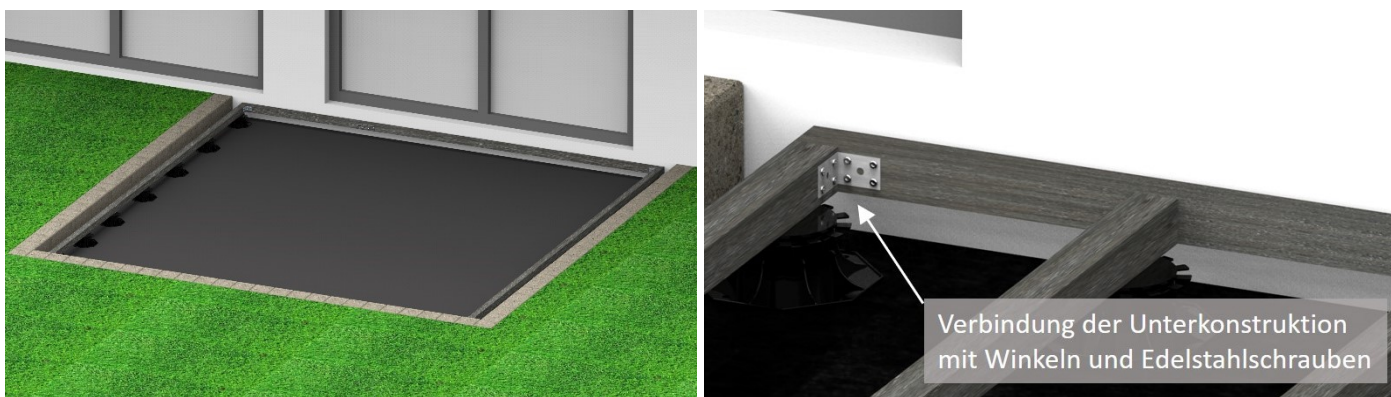
Bild 6 + 7. An den 2 äußeren Unterkonstruktionen werden mit Winkeln die vordere und hintere Unterkonstruktion befestigt.
