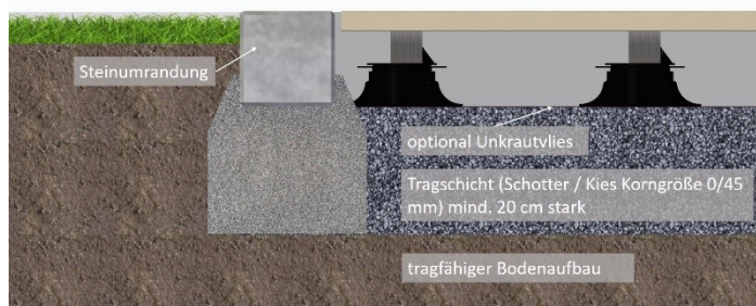
Bild 1. Die Tragschicht sollte ca. 20 cm stark sein.
