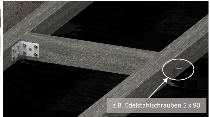
Bild 9. Die Querstücke können mit Winkeln befestigt werden oder durch die längslaufende Unterkonstruktion geschraubt werden.
