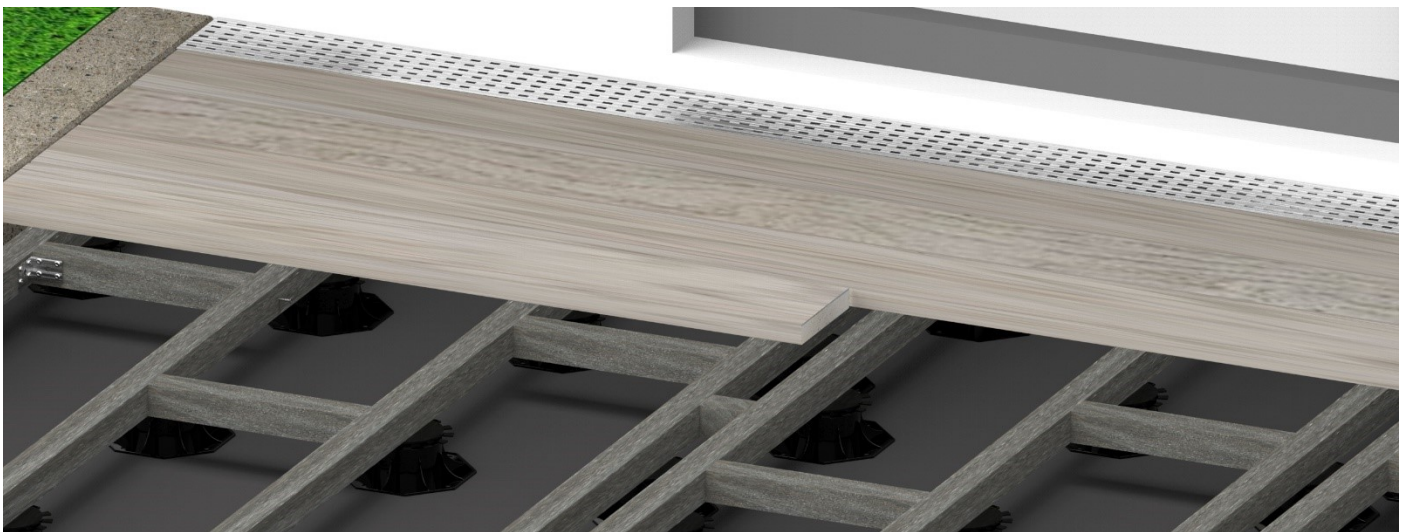
Bild 13. Terrassendielen können auf 2 Unterkonstruktion in der Länge mit offenen Fugen gestoßen werden.
