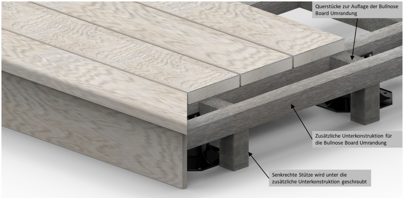
Bild 18. Eine zusätzliche Unterkonstruktion ist für die Auflage der Bullnose Board Umrandung erforderlich. Die Stützen müssen auf die Bauhöhe der Terrasse abgestimmt sein und zusammen mit den Querstücken und der Unterkonstruktion an der Rahmenkonstruktion der Terrasse verschraubt werden.
