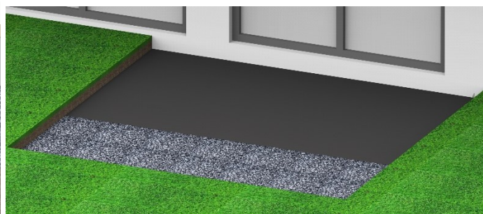
Bild 2. optional kann ein Unkrautvlies verwendet werden.
