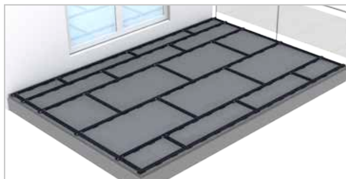
Verwindungssteifer Rahmen mit DREAMDECK ALU UK flach.
